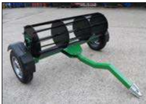
Photographie représentant un rouleau brise-fougère ( http://www.brackenbruiser.co.uk )
