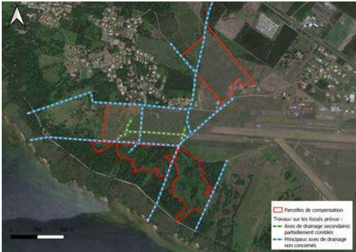
Figure 5 : Travaux sur fossés prévus (Source : ENVOLIS)
