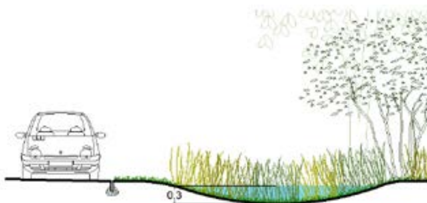
Figure 8 : Coupe de principe des fossés de collecte (Source : VERDI)
