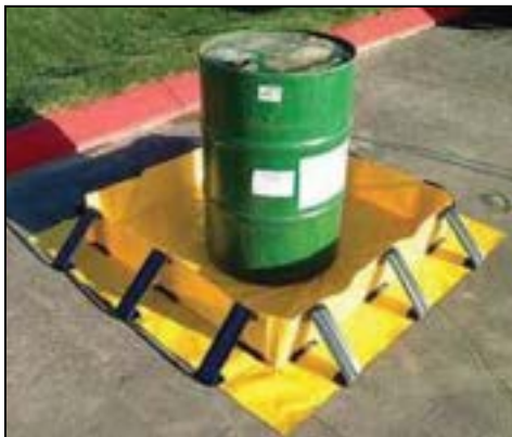
Figure 36 : Stockage de produit dangereux au sein d'un bac étanche (Source : Préfecture du Puy de Dôme)
